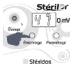
L'étalonnage est automatique, il se termine quand la valeur est fixe à 470 mV
