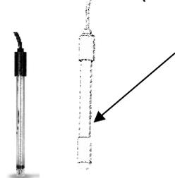
Retirer le capuchon de la sonde redox (peut être conservé pour l'hivernage de la sonde, voir paragraphe hivernage).
